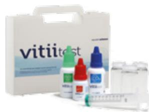
Vitiitest est un test colorimétrique permettant d'évaluer l'acidité (pH), la teneur en carbonates et la concentration en minéraux de l'eau.
