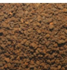
Le Phosphosorb P+ : 1kg de substrat peut absorber 12 à 16 g de P (soit 36 à 49 g de phosphates) dans les conditions optimales. La capacité est diminuée si d'autres ions interfèrent (essentiellement les métaux lourds qu'il absorbe également). Phosphosorb P+ ne se régénère pas et doit être remplacé une fois à saturation.
